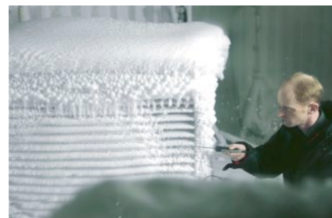
In de klimaatkamer worden de units in extreme weersomstandigheden in werking gesteld en getest.
